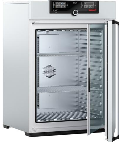
El sistema de calentamiento de este incubador está ajustado de forma óptima tanto para un sistema de circulación de aire forzada. Por este motivo, el ventilador se puede desconectar por completo con el fin de calentar cargas muy valiosas con especial cuidado en los sectores farmacéutico, médico, de la investigación y la química de los alimentos.
